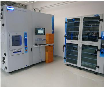
Um diese Ziele weiterhin zu erreichen, hat Lacon sich entschlossen, das Materialhandling in der SMD-Produktion durch den Einsatz eines ISM-Lagersystems von JUKI zu automatisieren. Neben der Automatisierung der klassischen Lagerhaltung war der Lacon GmbH ein automatisierter Abgleich mit dem produktionsunterstützenden System in der Produktion und dem ERP-System sehr wichtig.
