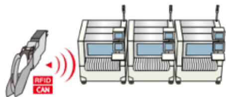
Der intelligente Feeder prüft kontaktlos via WLAN, ob sich das richtige Bauteil auf der Rolle befindet und verriegelt im Fehlerfall.
