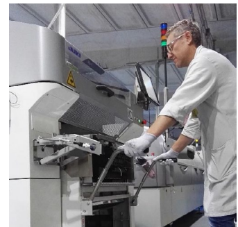
Jede Feeder-Position wird automatisch erkannt, wenn die Feeder-Bank positioniert wird. (Bild: NES)
